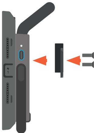
Montare la piastra di fissaggio come mostrato in figura. Serrare le viti utilizzando la chiave a brugola in dotazione.
