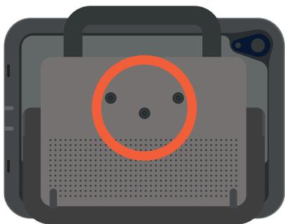
Individuare i fori in cui installare le apposite viti sul retro del dispositivo.
