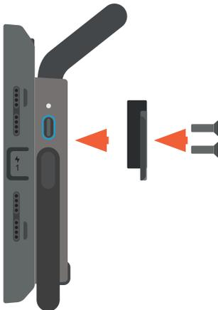
Befestigen Sie den Montage-Adapter wie abgebildet. Ziehen Sie die Schrauben mit dem mitgelieferten Inbusschlüssel fest.
